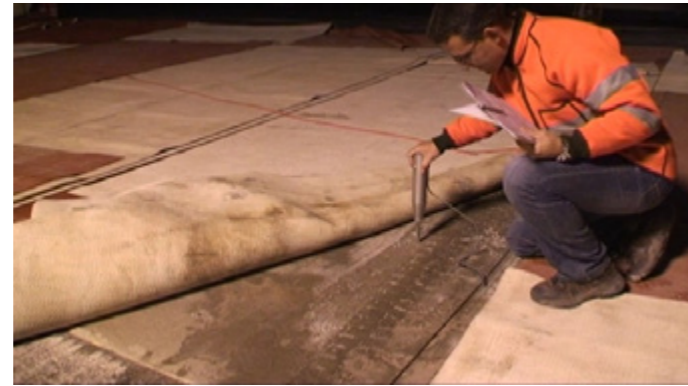
Mesure sur chantier de la résistance à la compression
